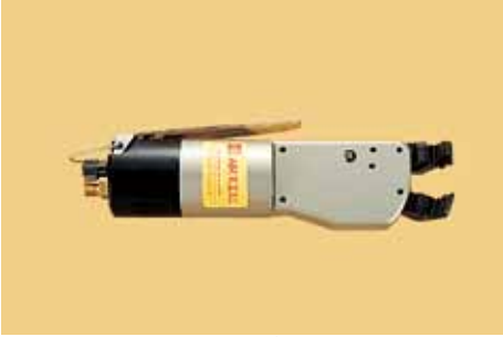
型號：BN-19（氣動式） 總長：165mm 重量：500g 氣體壓力：5 ~ 6kg/cm 2 氣體消耗：160cm 2 /stroke
